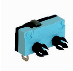
Pions de fixation pour épaisseur 2,5 mm et trous Ø 4mm (79253576)
