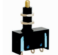
Poussoir télescopique avec surcourse CRA = 3 mm et canon fileté M6 x 0,75
