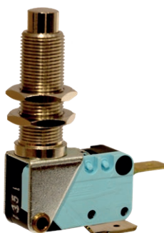
Poussoir télescopique et fixation réglable. Surcourse CRA = 4 mm. Version métal pour conditions difficiles. Canon long
